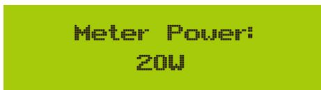
Рис. 7.36 Функція нульового експорту через увімкнення лічильника електроенергії
